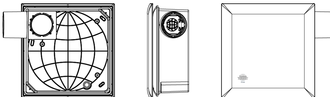
Rys. 4.4: Położenie króćca w wentylatorach eVI S
